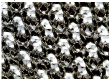
Рисунок - Зображення розробленого зразка трикотажу двошарового переплетення (лицьова та виворітна сторони)
