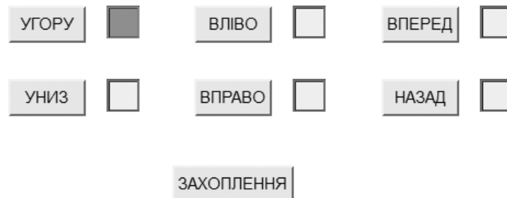
Рис. 8. Застосування MasterSCADA для найпростішого керування промисловим роботом МП-9С
