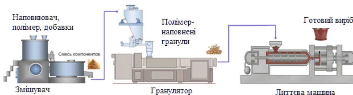
Рисунок 1 – Технологічна схема лиття під тиском виробів з полімерних композицій
