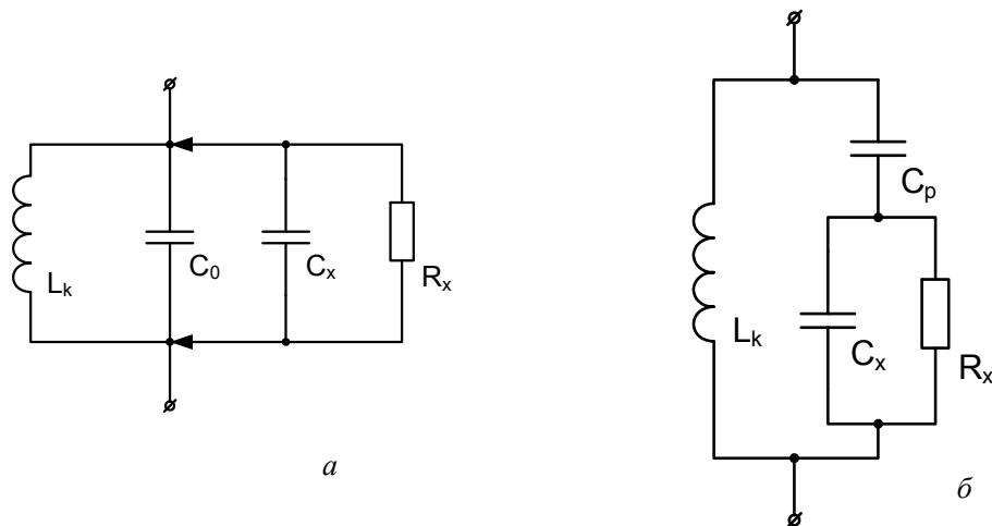
Рис. 1. Параллельный колебательный контур с емкостным датчиком:
