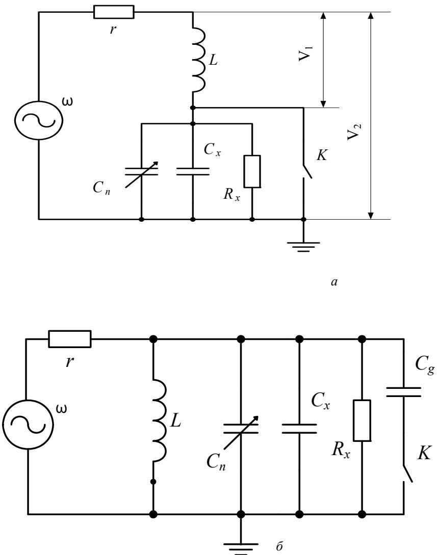
Рис.3. Схемы измерения емкости методом сравнения напряжений на двухполюснике при параметрической модуляции
