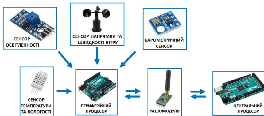
Рис. 4. Структурна схема моніторингу параметрів оточуючого середовища
