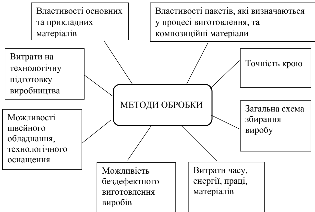
Рис. 4.1. Фактори, які впливають на вибір методів обробки
