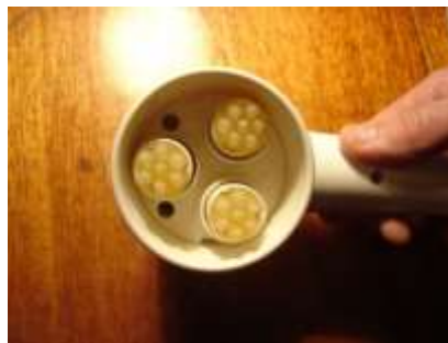
Рис. 3.10. Принципова схема (а) та зовнішній вигляд (б) пристрою для визначення здатності до очищення текстильних матеріалів
