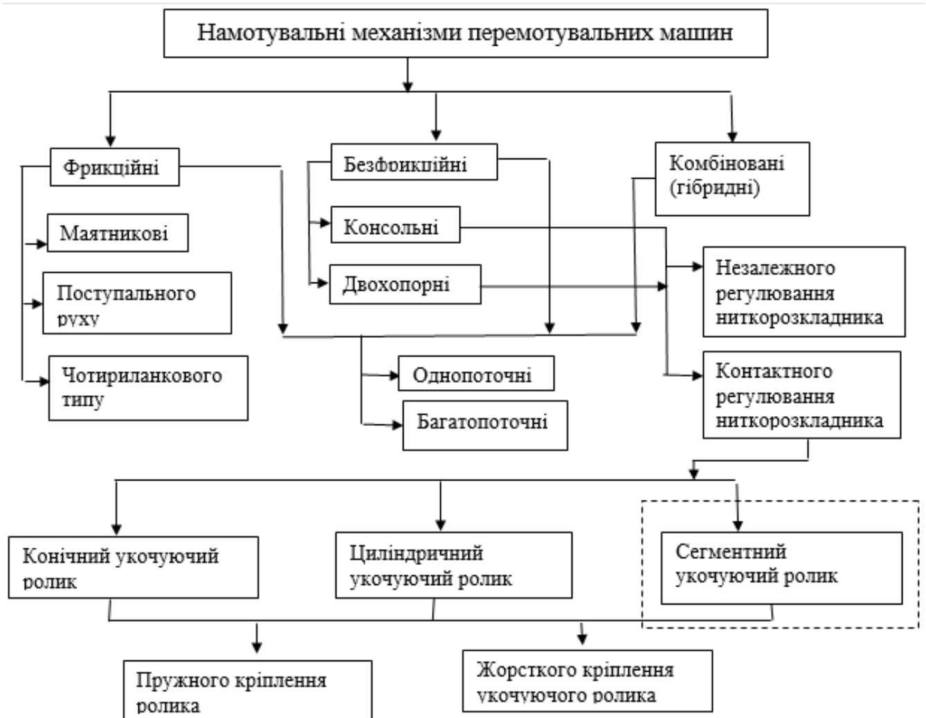
Рисунок 3.1 – Класифікація механізмів намотування
