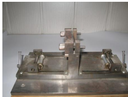
Рис.4.1. Експериментальна установка: а – загальний вигляд; б – блок апаратури для реєстрації; в – блок моделювання взаємодії ниток з напрямними
