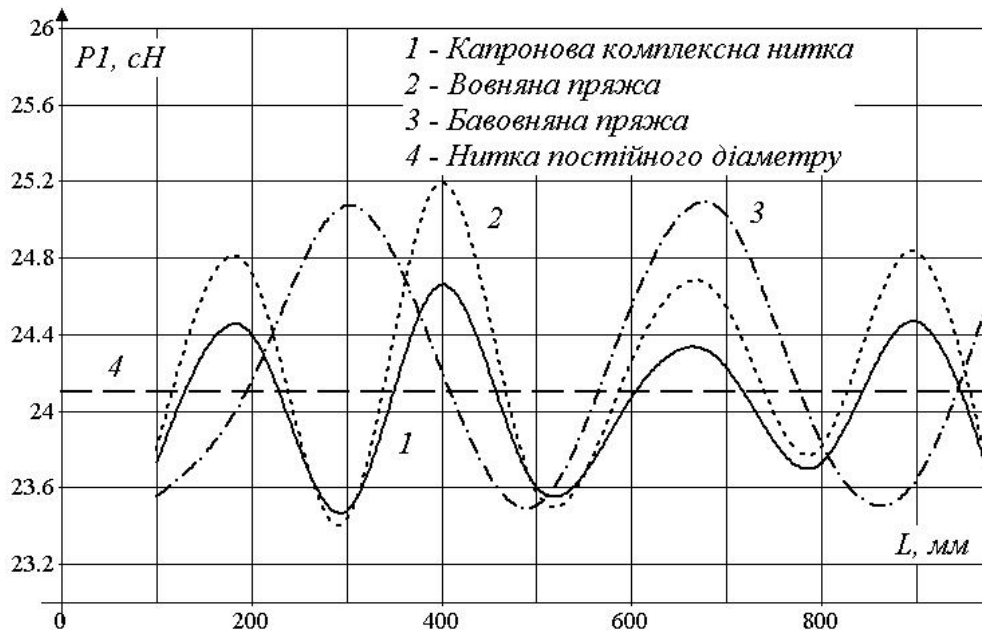
Рис.3.5. Залежності зміни натягу пальцевого пристрою для натягу нитки круглов'язальних машин великого діаметру
