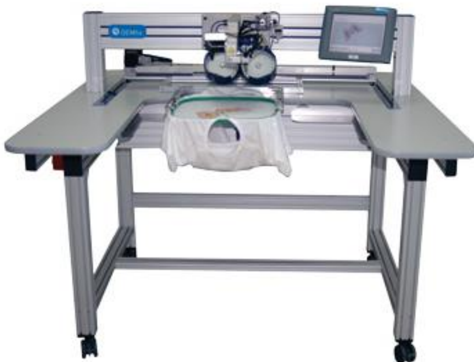
Рисунок 2.7 - Автомат для установки стразів GEMFIX ULS 240-423B.
