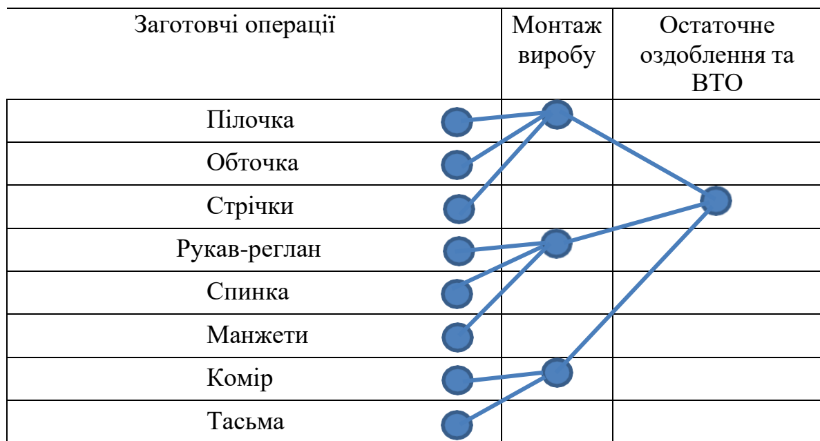
Рис.3.8. Схема технологічного процесу виготовлення піджаку
