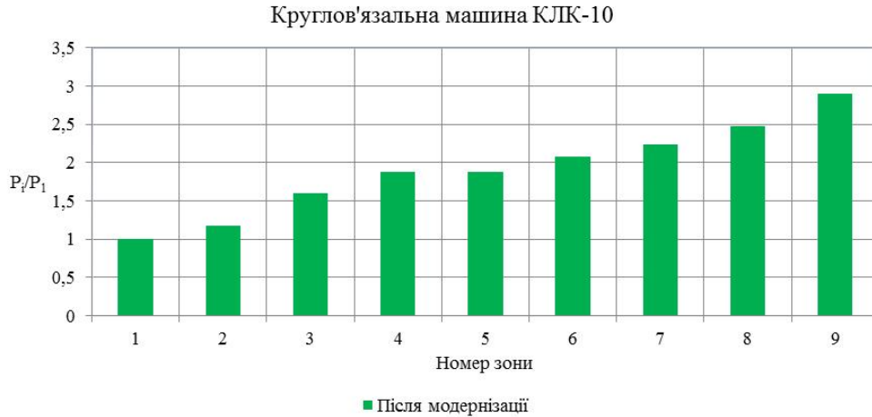
Рис.8.4.16. Діаграма зміни відносного натягу нитки у зонах заправки круглов'язальної машини КЛК – 10 після оптимізації форми лінії заправки
