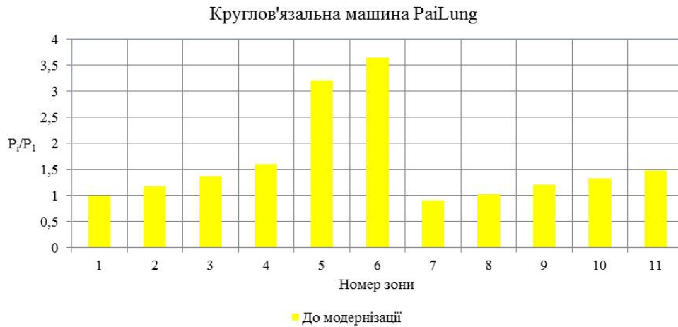
Рис.8.4.22. Діаграма зміни відносного натягу нитки у зонах заправки круглов'язальної машини PaiLung
