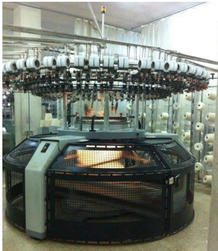
Рис.8.4.17. Форма лінії заправки ниток круглов'язальної машини Мауер
