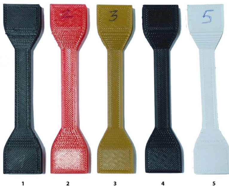
Рис. 4.15. Надруковані досліджувані зразки з різних видів пластику: 1 – Elasthan D70; 2 - PETg; 3 – PLA; 4 – ABS; 5 – PCTG
