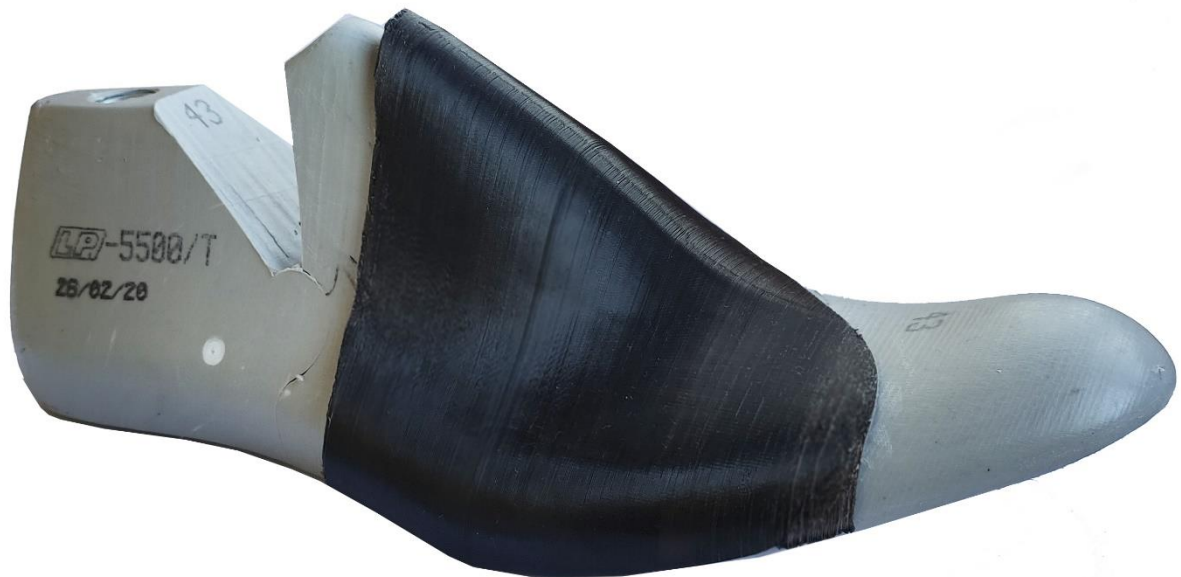
Рис. 4.24. Прикріплена друкована індивідуальна накладка на колодку
