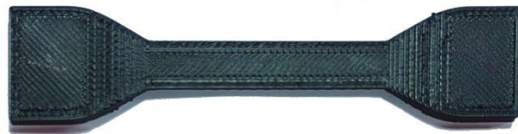
Рис. 2.17. Надруковий досліджуваний зразок з пластику Elasthan D70
