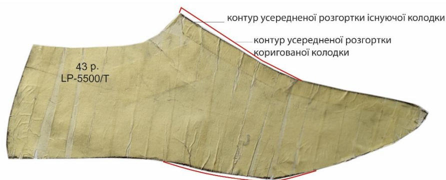
Рис. 4.35. Порівняння УРК існуючої та коригованої колодки
