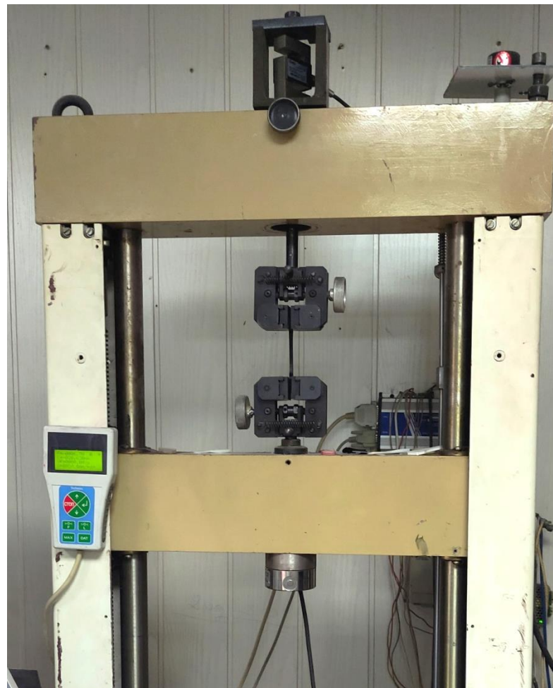
Рис. 2.20. Досліджуваний закріплений зразок на модернізованій розривній машині 2167 P-50
