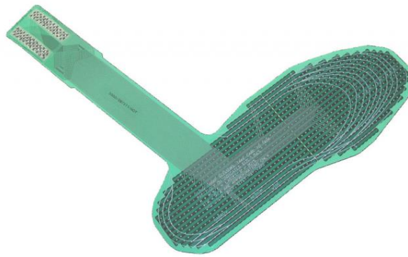
Рис. 1.3. F-Scan – внутрішньо-взуттєва педографія на основі тонкоплівкових (товщина 0,1 мм) резистивних устілок
