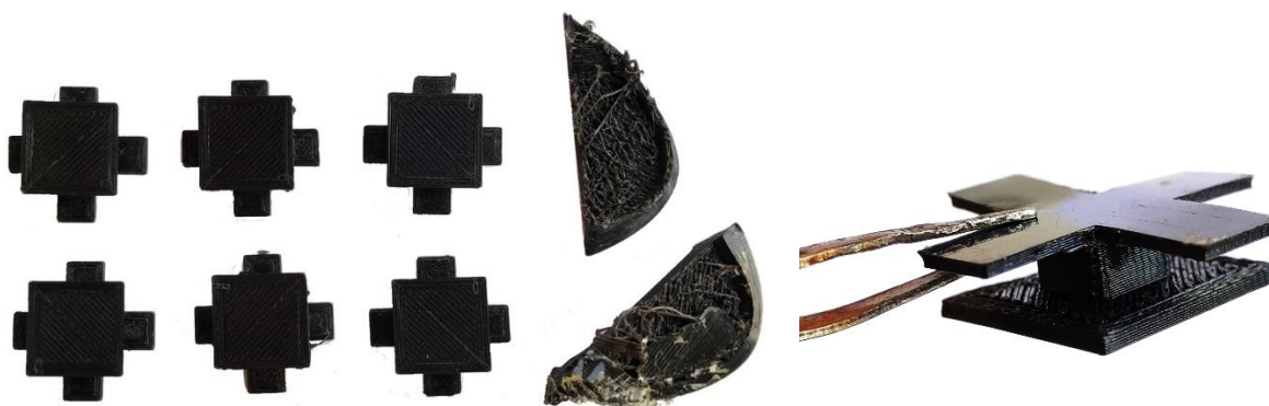
Рис. 2.15. Зразки експериментальних деталей з Elasthan D70 для підбору параметрів друку підтримки
