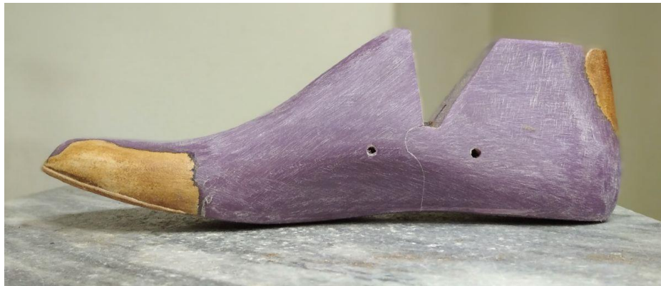
Рис. 1.11. Приклад коригування індивідуальної колодки личинами
