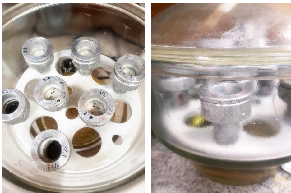
Рис. 2.28. Паропроникність склянки над кислотою
