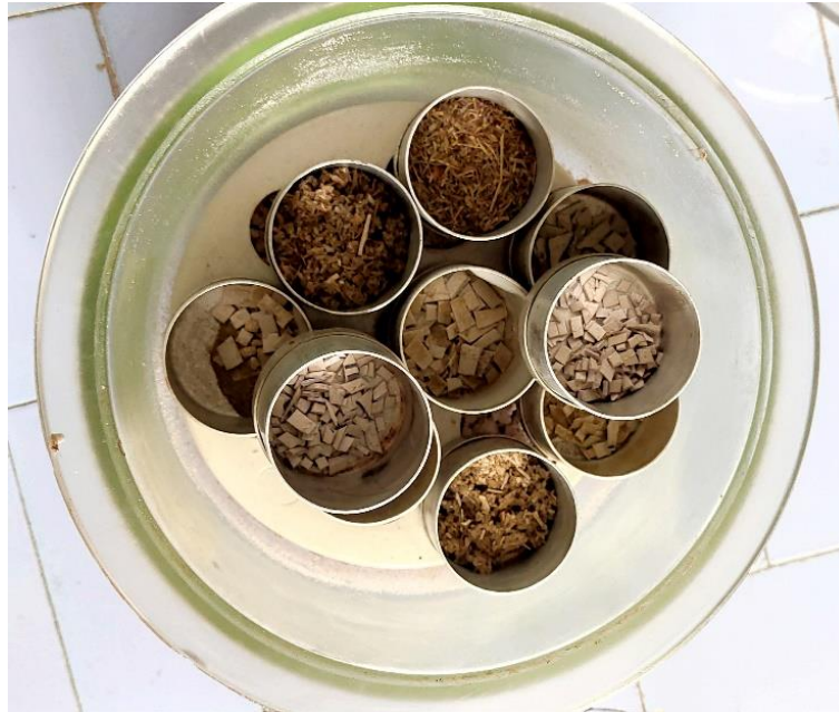
Рис. 2.29. Визначення вологовмісту досліджуваних матеріалів
