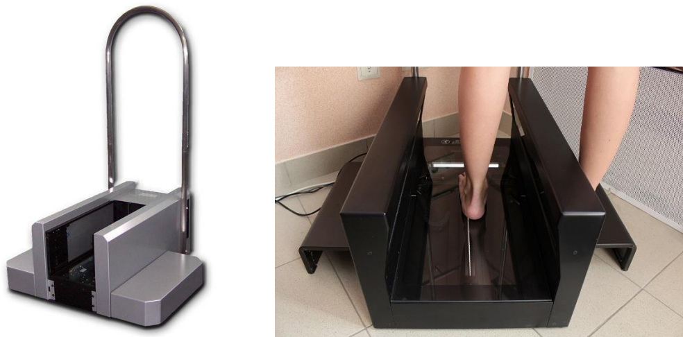
Рис. 1.10. а) - 3D сканер або INFOOT 3D; б) - Процес сканування стопи
