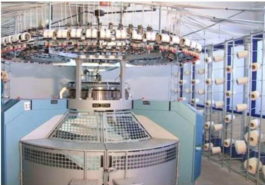
Рис.8.4.21. Форма лінії заправки ниток круглов'язальної машини PaiLung
