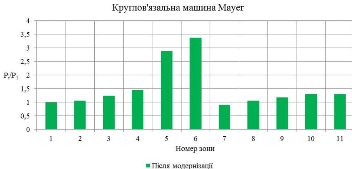
Рис.8.4.20. Діаграма зміни відносного натягу нитки у зонах заправки круглов'язальної машини Mayer після оптимізації форми лінії заправки
