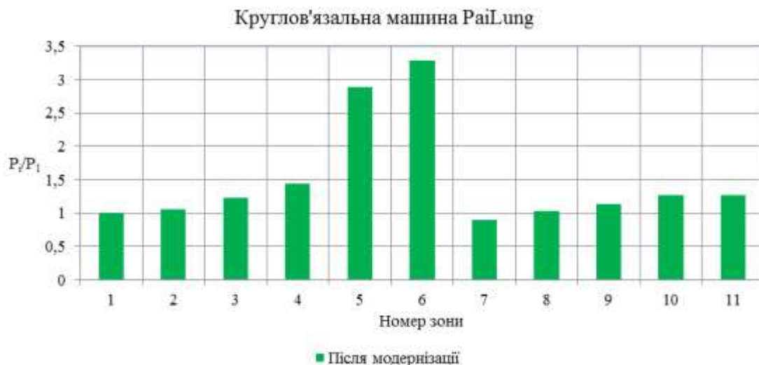
Рис.8.4.24. Діаграма зміни відносного натягу нитки у зонах заправки круглов'язальної машини PaiLung після оптимізації форми лінії заправки
