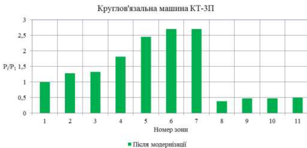
Рис.8.4.4. Діаграма зміни відносного натягу нитки у зонах заправки круглов'язальної машини КТ-3П після оптимізації форми лінії заправки Удосконалення системи подачі ниток круглов'язальної машини МС
