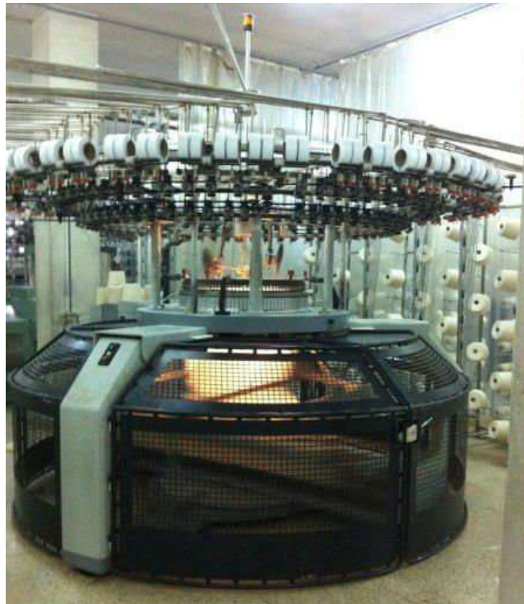
Рис.8.4.17. Форма лінії заправки ниток круглов'язальної машини Мауер
