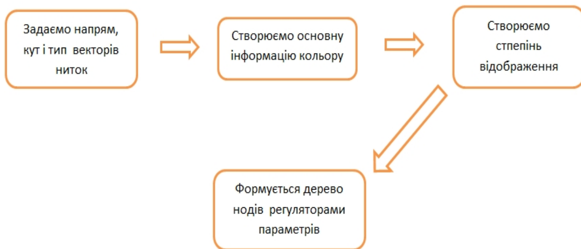
Рисунок 3 - Метод створення PBR шейдера тканин
