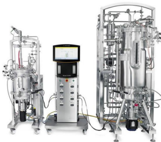
Рис. 2.2 Ферментер BIOSTAT D-DCU (Німеччина) для культивування дріжджів Saccharomyces cerevisiae [138].
