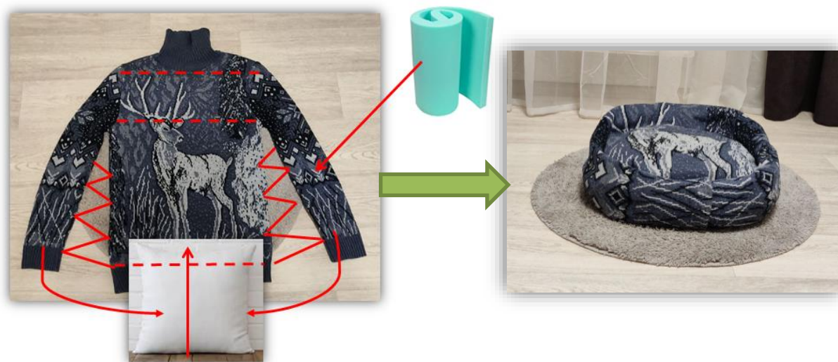
Рис. 2. Схема процесу виготовлення лежачка для тварин у техніці апсайклінг з трикотажного джемпера
