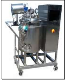
Рис. 2.12. Мобільний (пересувний) реактор об'ємом 125 л (сталь AISI 316)
