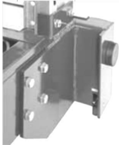
Рис. 1.4 – Кріплення датчиків світлового затвора і положення на відсіку
