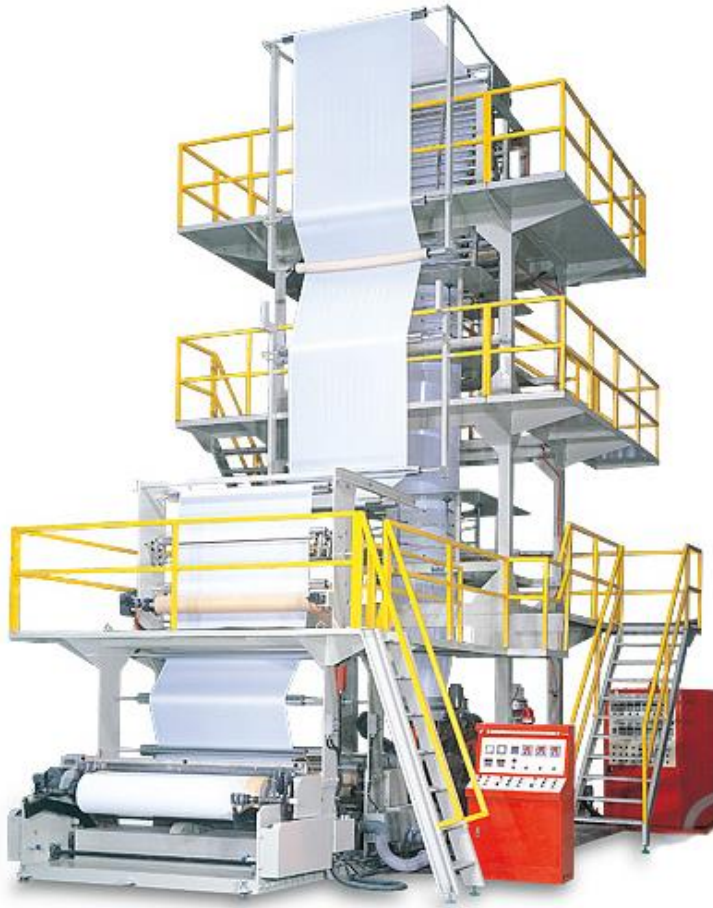
Рис. 1.2. Екструзійна лінія для виготовлення рукавної плівки
