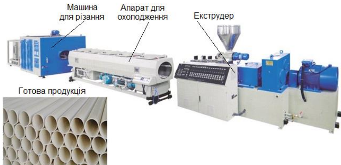
Рис. 1.1. Екструзійна лінія для виготовлення труб
