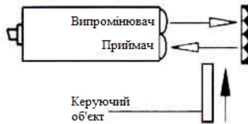
Рис. 2.6. Схема моноблочного поляризованого оптичного датчика
