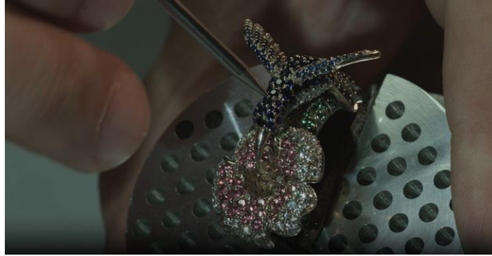
Рис. 2.8. Процес закріплення каміння в ювелірний виріб [39]
