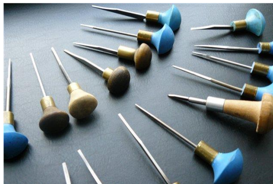
Рис. 2.9. Інструмент для гравіювання штихель [41]
