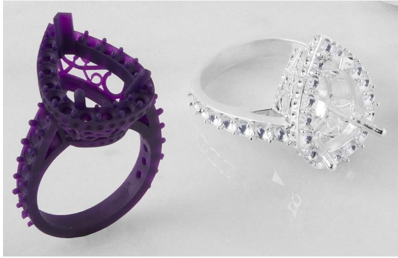
Рис. 1.28. Надрукована на 3D-принтері модель та відлита по ній каблучка у металі [30]
