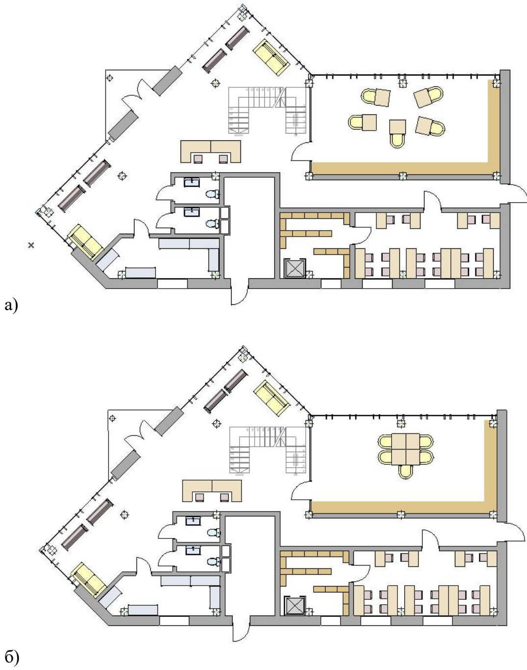
Рис. 3.6. План меблів першого поверху: а) варіант з вільним плануванням коворкінгу; б) варіант коворкінгу для групової роботи
