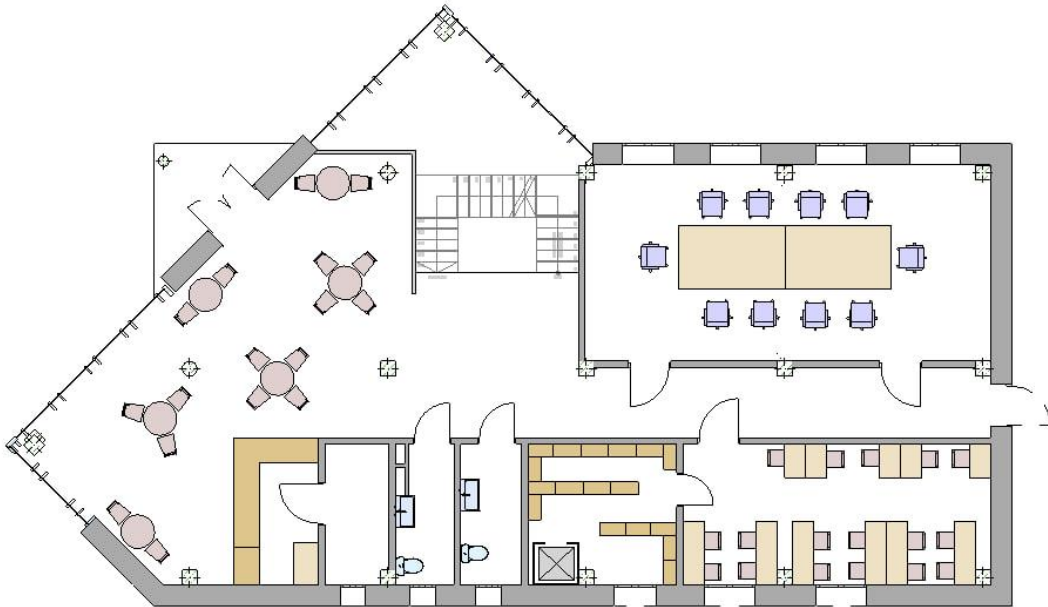
Рис. 3.7. План меблів другого поверху: а) варіант для двох груп що розділяється роздвижною перегородкою; б) варіант для однієї великої групи
