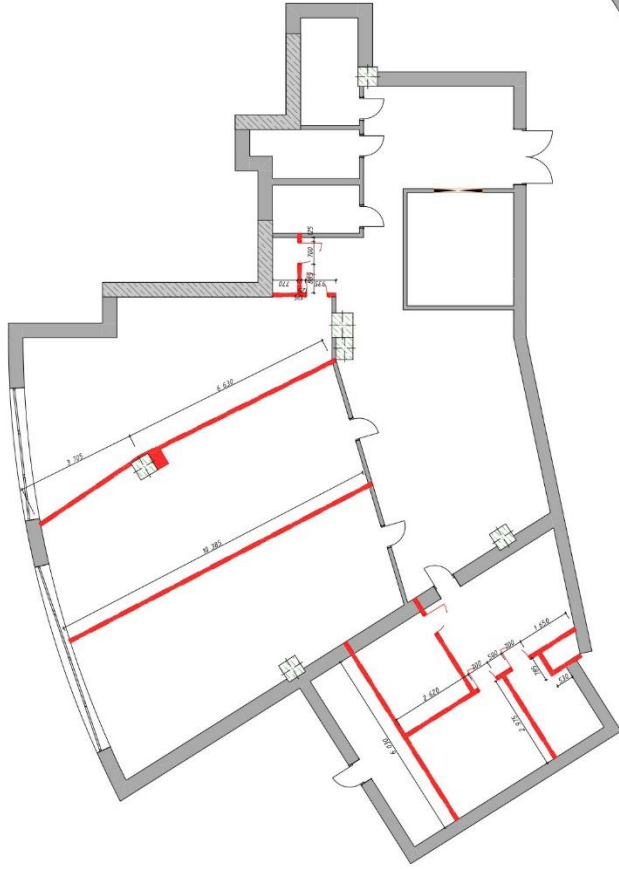
План демонтажу перегородок
