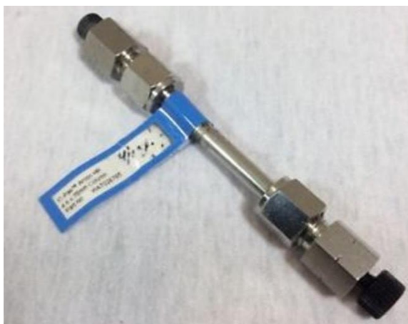
Рисунок 1.9 Аніонна колонка Waters IC-Pak Anion HR Column, 4.6 x 75 mm - WAT026765
