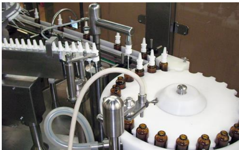
Рисунок 3.1 Процес укупорки флаконів
