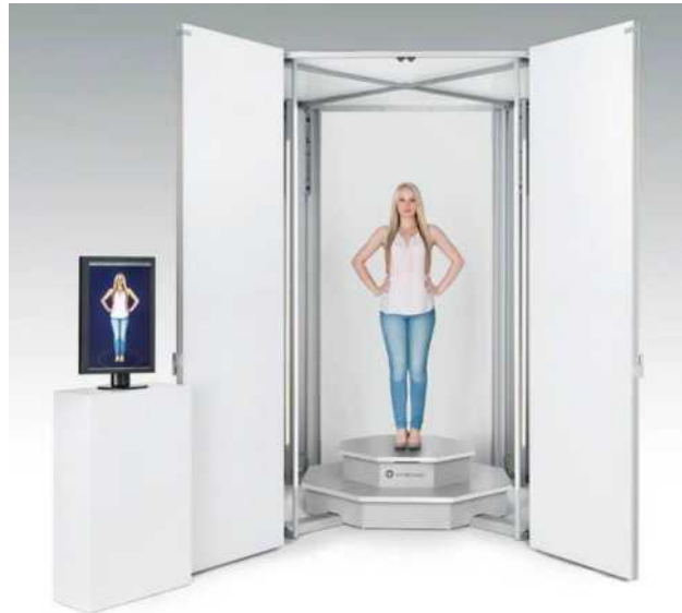
Рисунок 3 – Скануюча 3D - установка Vitus Bodyscan .
