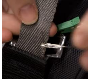
Рис. 2. Фото п'єзоелектричної пряжі та електропровідної нитки в ремінь сумки.
