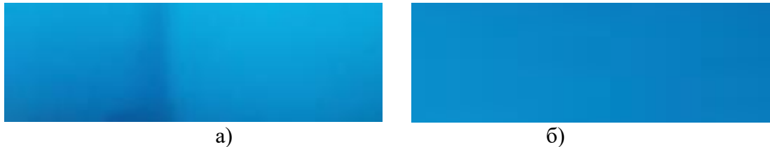
Рис. 2 – Фото труби виготовленої з ПВХ-композиції з додаванням стабілізатора а) Kimstab EPS 2100-22 FC та б) Ваеропан МС 91424 FP/1.
