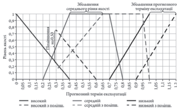
Рис. 3.11. Динамічна модель прогнозування рівня якості необоротних матеріальних ресурсів при поліпшенні
