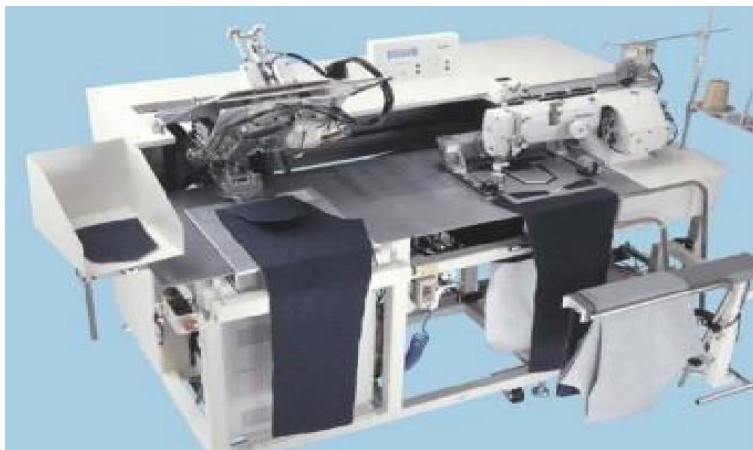
Рис. 13. Автомат JUKI AVP-875S, що пришиває кишені в джинсах
