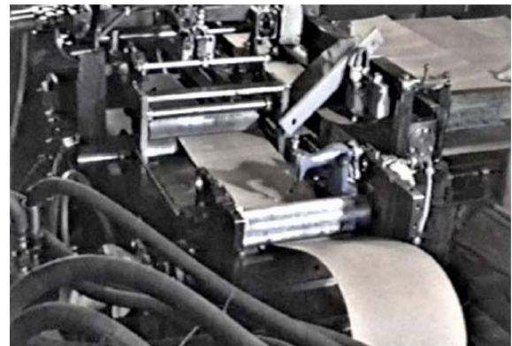
Рис. 6. Механізм валкової покрової подачі смуги
