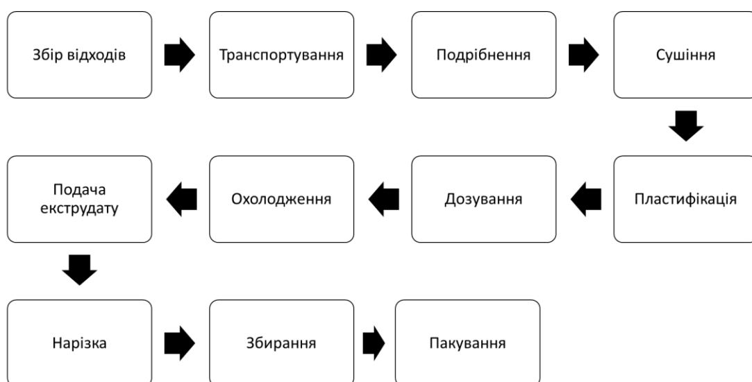
Рисунок 32. Технологічна схема отримання гранул з відходів ПКМ
