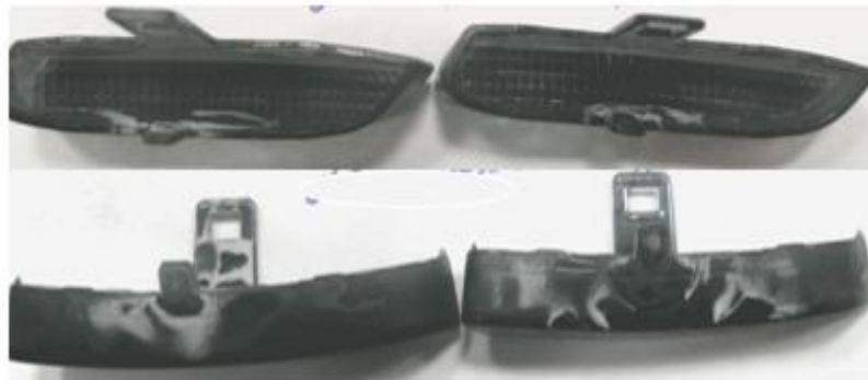
Рисунок 20. Загальний вигляд виробу з PA12 із застосуванням стандартних параметрів процесу після витримки в C_2H_5OH
