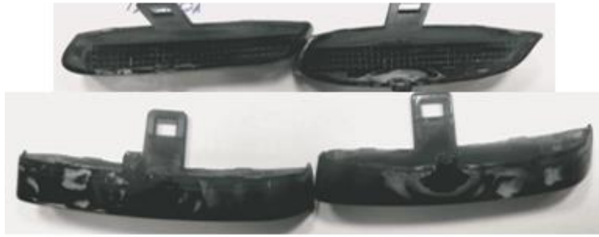
Рисунок 24. Загальний вигляд виробу з PA12 із збільшеною швидкістю впорскування після витримки в C_2H_5OH 96,6% об.
