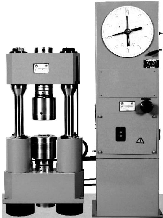
Рисунок 9. Машина для стиску типу ВП-1 для вимірювання модуля пружності
