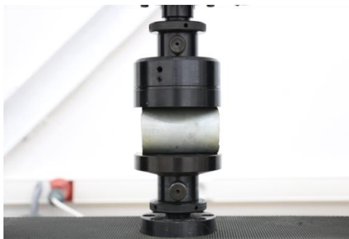
Рисунок 8. Розташування зразка для випробування на стиснення
