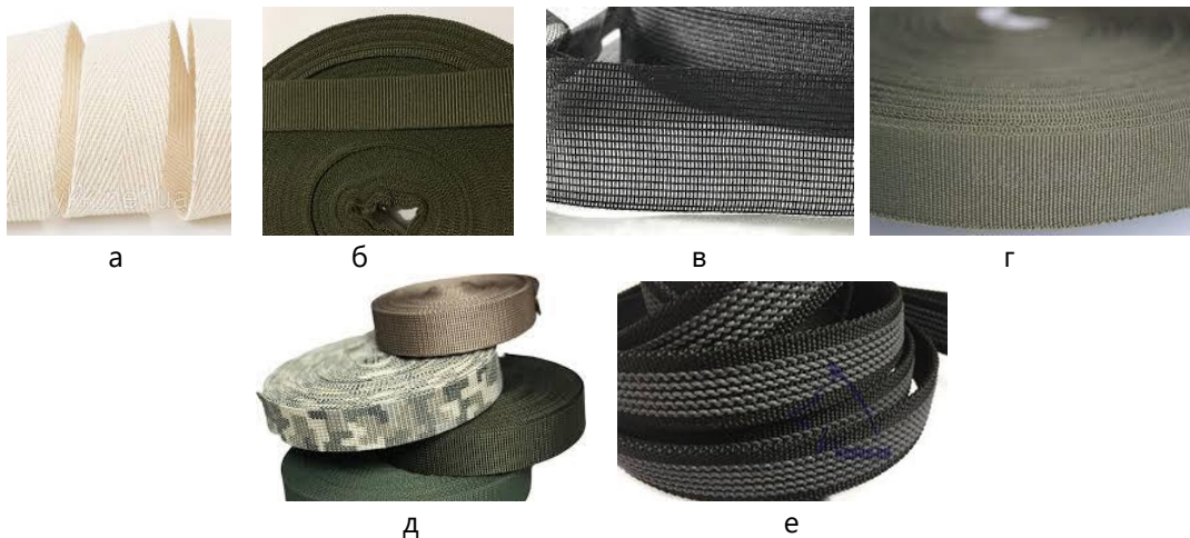
Рис. 4. Різновиди текстильної тасьми: а – кіперна; б – репсова; в – внутрішня; г – зовнішня; д – стропа; е – ремінна (стропа) посилена
