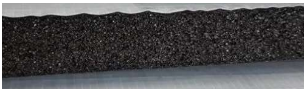
Рис. 2.8. Профіль мікропористої гумової підошви
