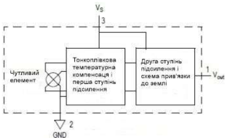
Рис. Г3 – Блок-схема інтегрального датчика тиску MPX5700DP фірми Motorola
