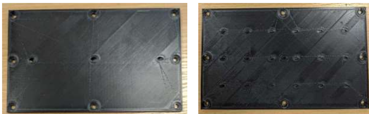
Рис. 3.11. Пластини з соплами виготовлені шляхом 3D друку:
