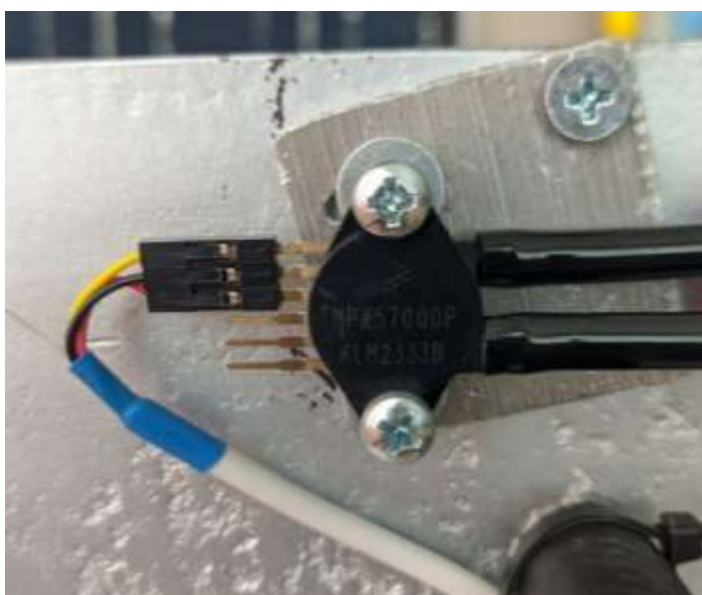
Рис. 3.3. Диференційний датчик тиску MPX5700DP фірми NXP
