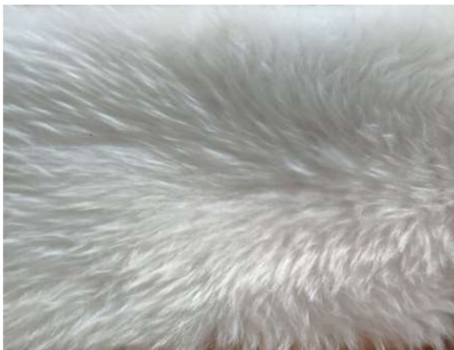
Рис. 2.12. Деформація ворса штучного хутра під дією струменя повітря
