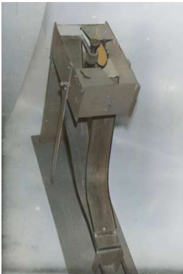
Рис. 1.17. Модель пристрою для контролю положення і орієнтації плоских деталей низу взуття за фрикційними властивостями поверхонь
