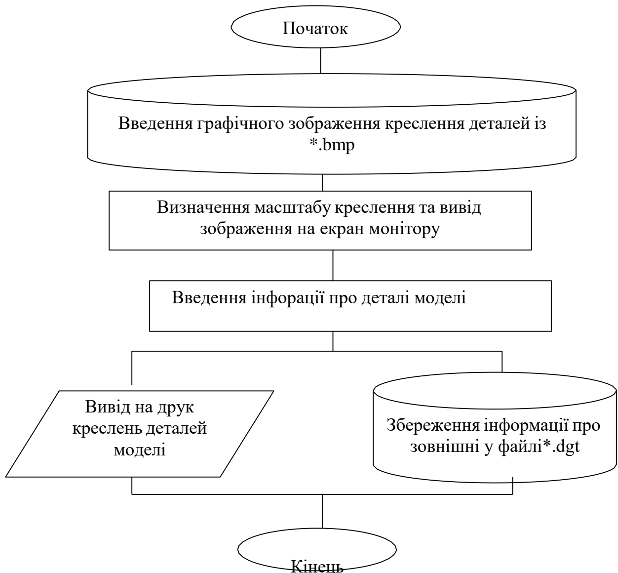
Рис. 2.2. Структурна схема алгоритму інтерактивної підготовки інформації про зовнішні контури деталей взуття
