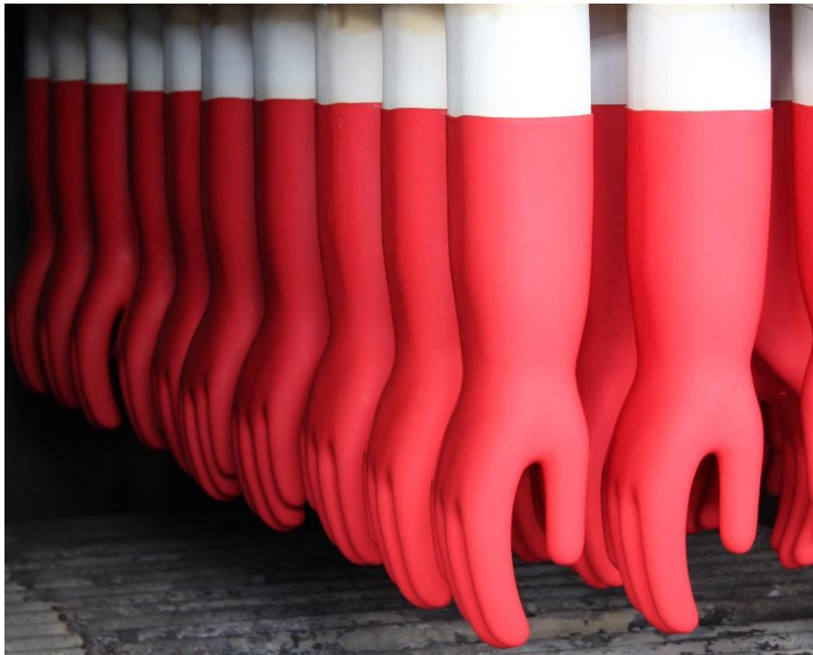
Рис. 2.5. Виготовлення за допомогою прес-форм методом прямого формування або лиття під тиском в прес-форму
