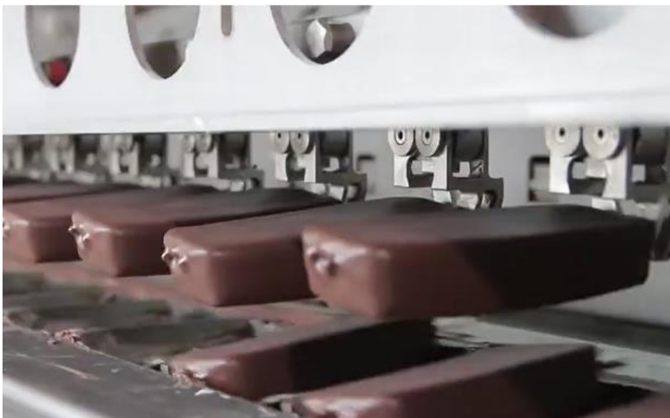
Рис. 2.6. Процес виробництва класичного морозива у молочному шоколаді на палочці компанії «Рудь»
