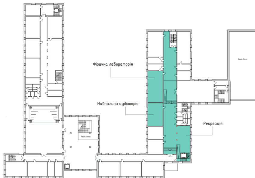
Рис. 2.13. Схема розміщення навчальної аудиторії, фізичної лабораторії та рекреації на плані другого поверху школи.
