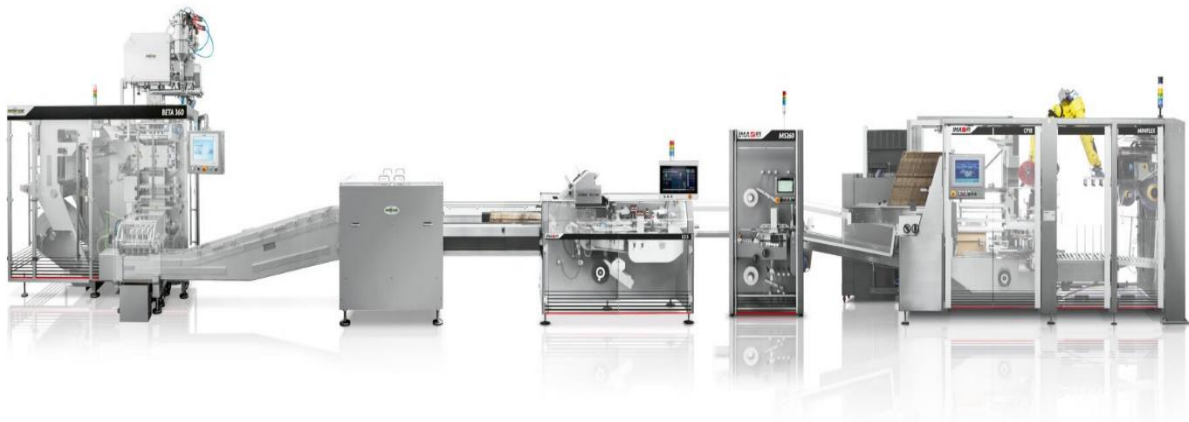
Рисунок 4.4 – Зовнішній вигляд комплексної лінії для формування, наповнення та запаювання пакетів-саше Beta 360
