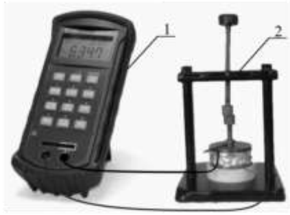
Рисунок 1 – Схема визначення питомого об'ємного електричного опору для зразка композиції: 1 – RLC-метр E7-22; 2 – електродний пристрій
