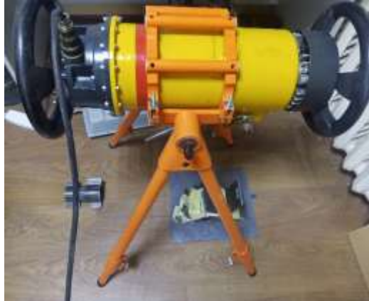
Рисунок 5 – Генератор рентгенівського випромінювання Baltospot GFD165
