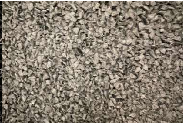
Рисунок 2 – Подрібнений брак та технологічні відходи ABS/PC
