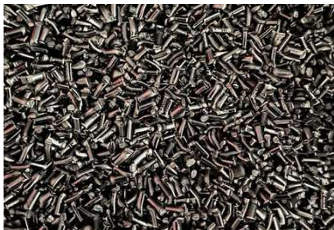
Рисунок 3 – Регранульований подрібнений матеріал ABS/PC
