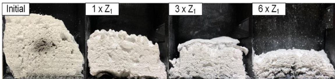
Рисунок 1.10 – Зовнішній вигляд коксу водородчинного інтумесцентного покриття до та після штучного старіння [44]
