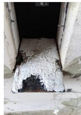
Вигляд зразку після вогневих випробувань
