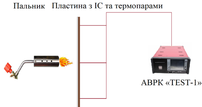
Рисунок 2.4 – Схема приладу «пальник Бунзена»
