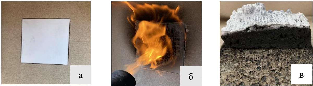
Рисунок 2.5 – Візуалізація вогневих випробувань за методом «пальника Бунзена»: а) вихідний зразок; б) вигляд спученого шару в процесі експерименту; в) вигляд спученого шару після випробувань
