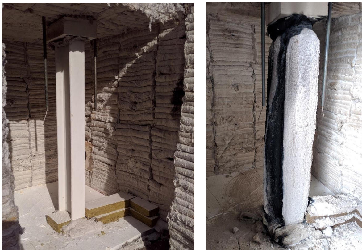
Рисунок 2. Зовнішній вигляд зразка до та після випробувань
