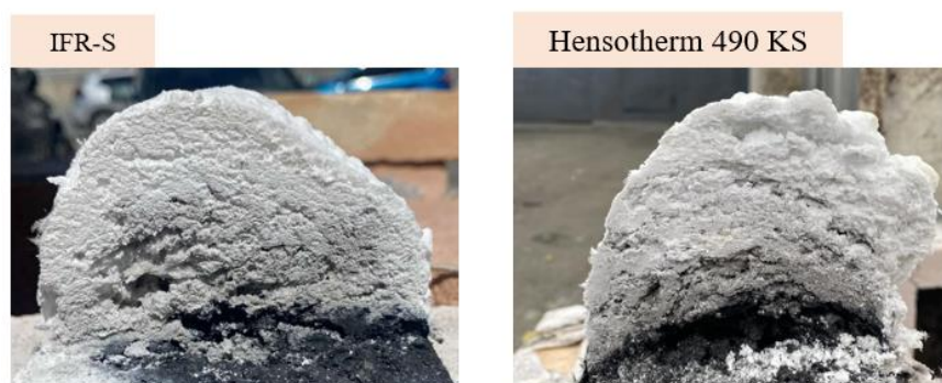
Рисунок 5.2 – Залежність температури зразка від температури полум'я та зовнішній вигляд коксових шарів після випробувань для покриттів IFR-S та Hensotherm 490 KS
