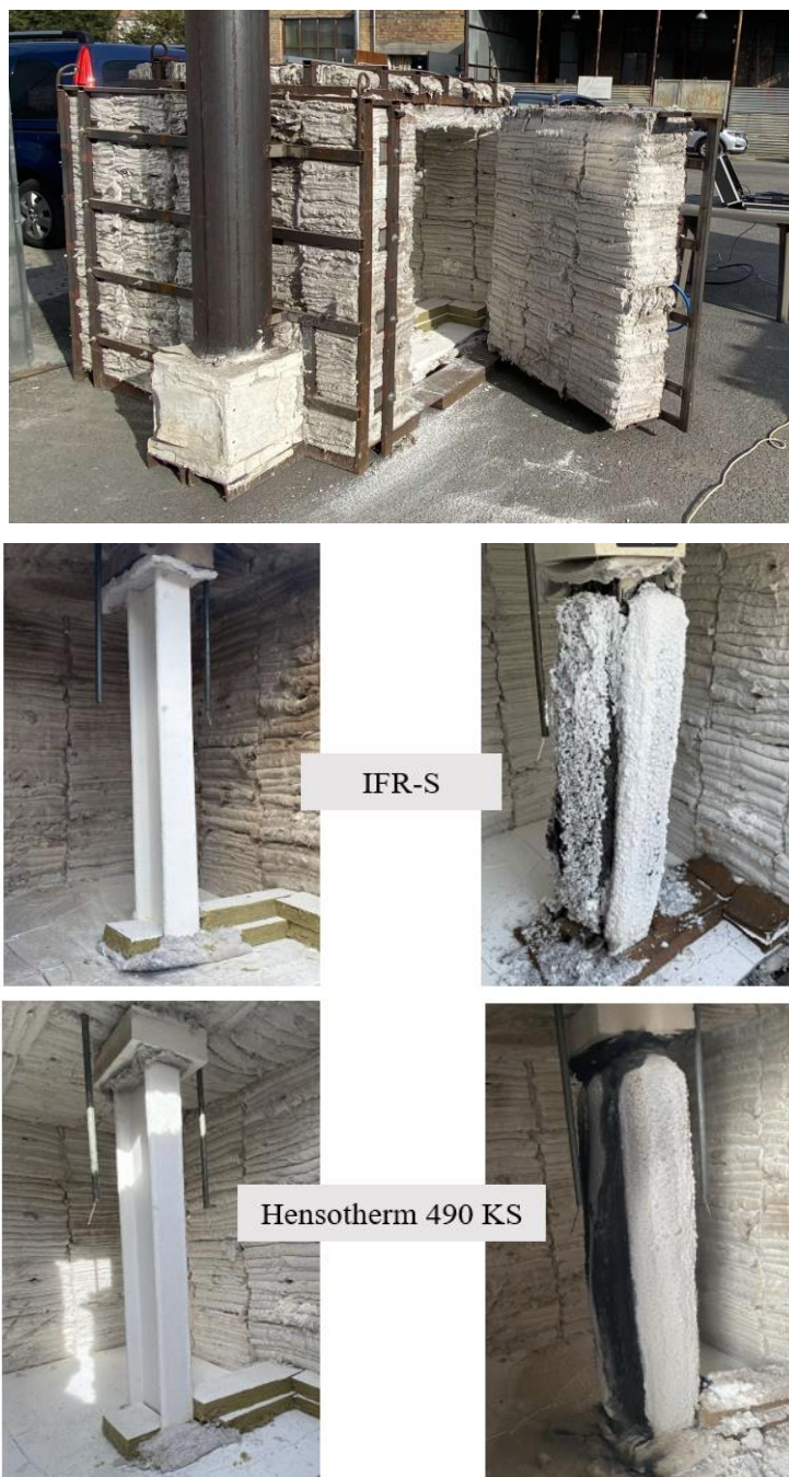
Рисунок 5.4 – Візуалізація випробувань сталевих колон, на які нанесені вогнезахисні засоби IFR-S та Hensotherm 490 KS
