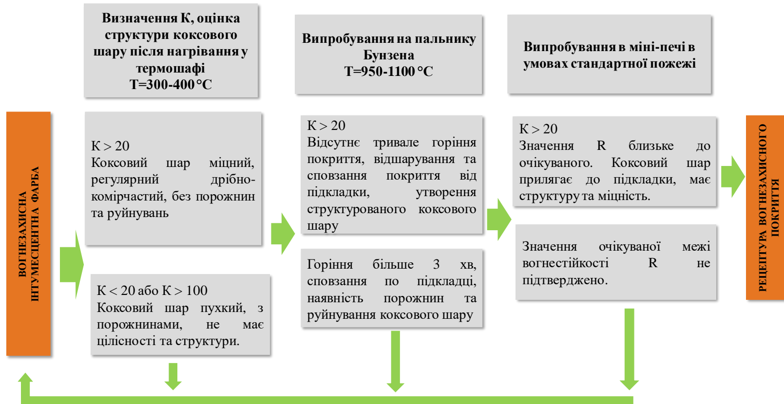
Рисунок 3.2 – Алгоритм випробувань вогнезахисної ефективності у процесі розробки рецептури інтумесцентного покриття
