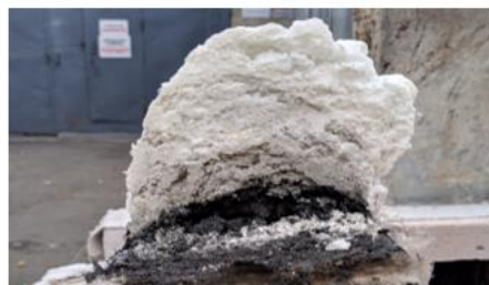
Рисунок 3.6 – Залежність температури зразка від температури полум'я та зовнішній вигляд коксових залишків IFR (табл. 3.4) після випробувань у міні печі
