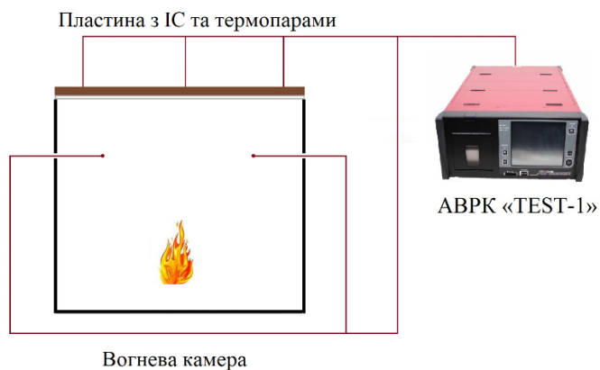
Рисунок 2.6 – Схема приладу «міні-піч»
