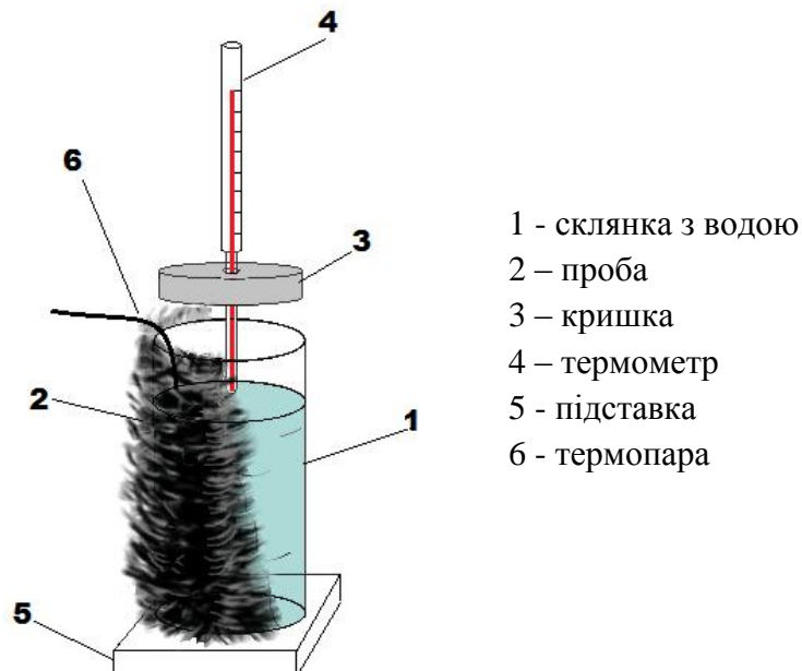
Рис. 1. Установка для визначення теплозахисних властивостей шкурок натурального хутра
