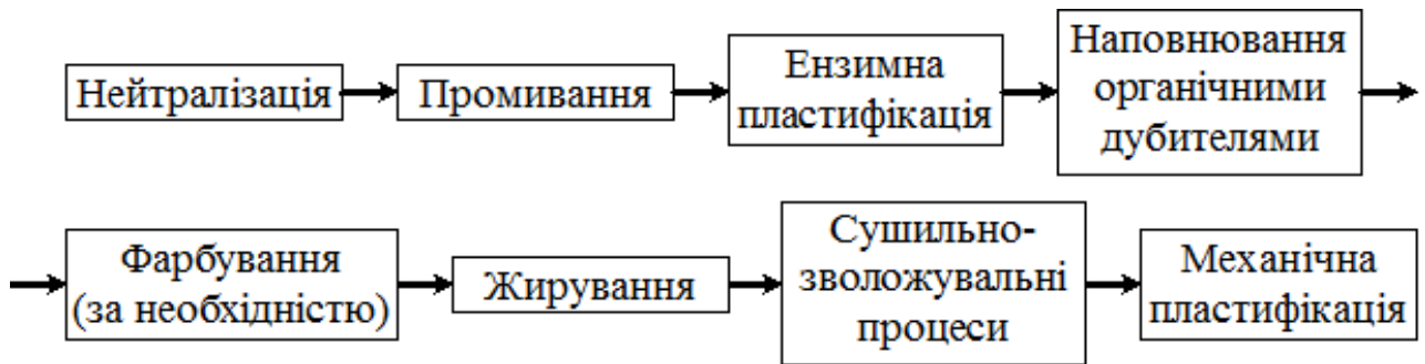
Рис. 1 – Технологічна схема виготовлення шкіри з ензимною пластифікацією напівфабрикату хромого дублення
