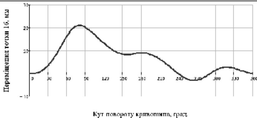
Рис. 4. Графік переміщення робочої точки механізму III класу 4 порядку
