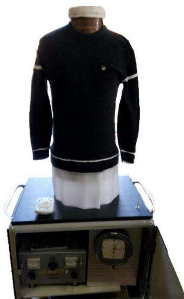
Рисунок 1 - Імітаційний стенд торсу людини
