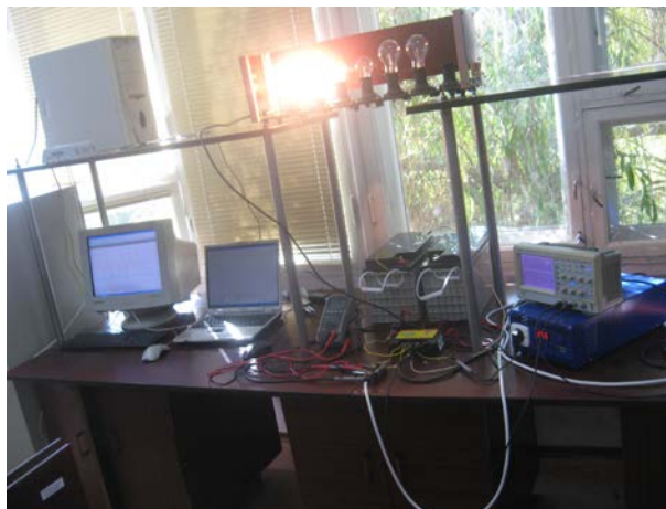
Рис. 4. Вузол зарядження-розрядження акумуляторних батарей
