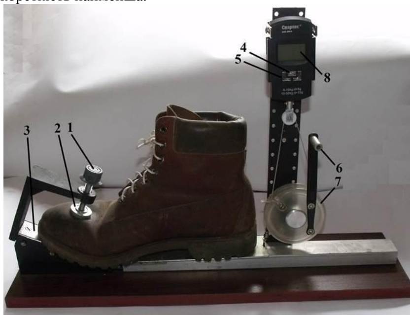
Рисунок – Стенд для визначення згинальної жорсткості взуття
