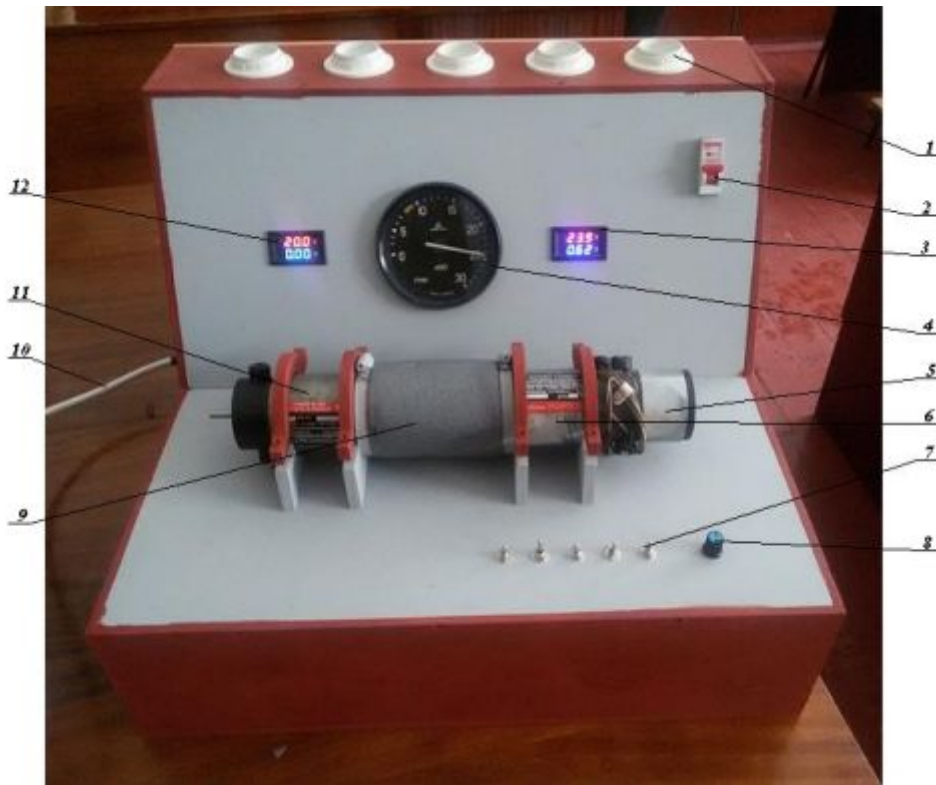
Рис. 2. Загальний вигляд стану для дослідження характеристик машин постійного струму із збудженням постійними магнітами
