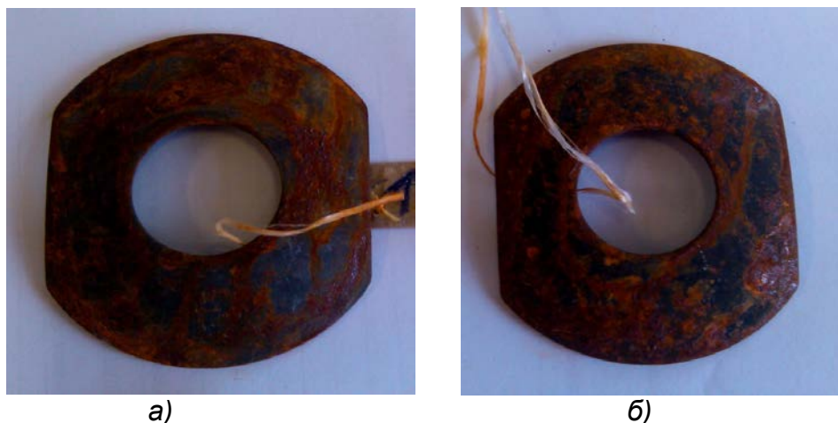
Рис. 3 Внешний вид покрытий после 10 часов испытаний: а – 2 образец; б – 8 образец.
