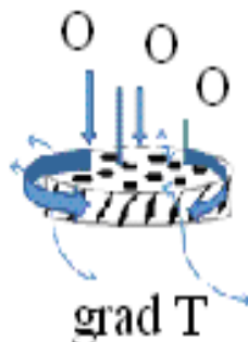
Рис. 3. Схема формування температурних градієнтів в системі \text{Fe}/\text{Fe}_3\text{O}_4/\text{C}/\text{NaCl}
